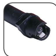
L'électrode est dotée d'une jonction tissu renouvelable améliorant sensiblement sa longévité. En cas d'encrassement, il suffit de tirer 3 mm de jonction propre.
