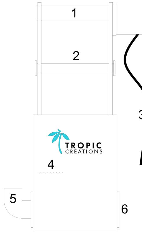
**Remarque :** Le voile doit être collé au tambour moteur à l'aide du sticker apposé sur le nouveau rouleau portant le marquage *Roller clean 100* puis en faisant tourner le tambour moteur d'un tour complet, le voile filtrant se resserrera sur le tambour moteur qui peut être placé à gauche ou à droite (3).
