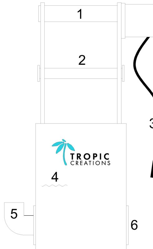
**Hinweis:** Das Vlies muss mithilfe des Aufklebers, der auf der neuen Rolle mit der Kennzeichnung **Roller clean 100** angebracht ist, an der Motortrommel festgeklebt werden. Wenn dann die Motortrommel um eine volle Umdrehung gedreht wird, zieht sich das Filtervlies an der Motortrommel fest, **die links oder rechts platziert werden kann (3).**
